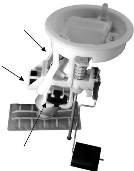
1 : Extraire la pompe du bloc pompe d'origine en enlevant les 3 cylindres bloc en caoutchouc.
