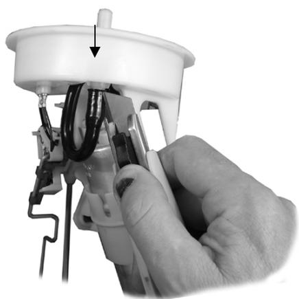
2 : Couper la durite Polyamide dans le sens de la LONGUEUR de façon à pouvoir l'extraire en prenant soin de laisser un espace lisse pour y fixer un collier de serrage.
